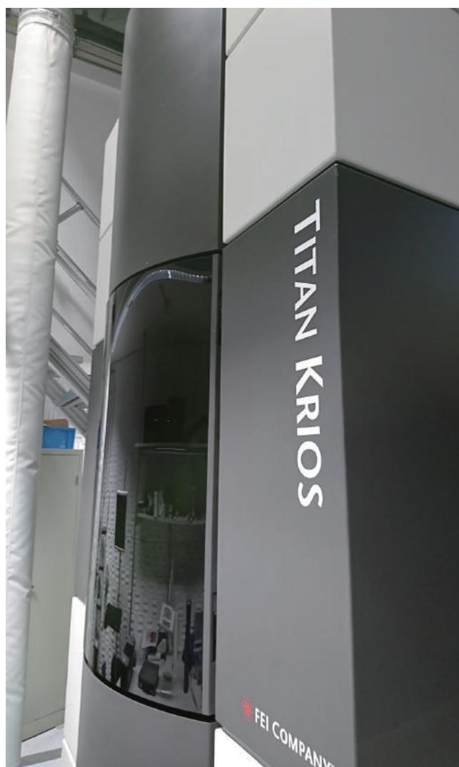
図1：クライオ電子顕微鏡の最上級機 Titan Krios
