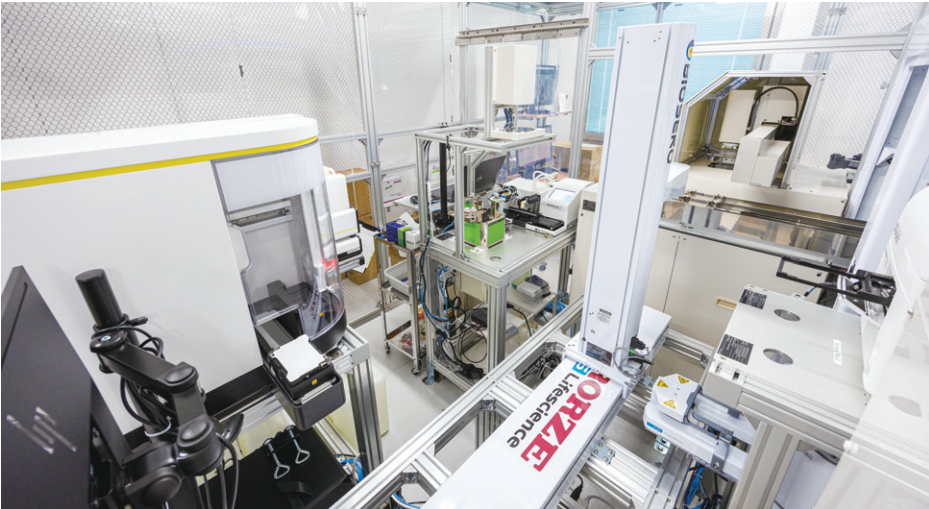
薬剤感受性プラットフォーム。ゲノム解析では予測困難な腫瘍細胞の抗がん剤感受性を解析。従来、人が行っていた部分を全自動化している。第一三共との共同研究として実施されている。
