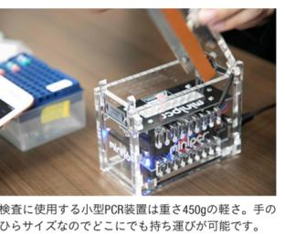
検査に使用する小型PCR装置は重さ450gの軽さ。手のひらサイズなのでどこでも持ち運びが可能です。
