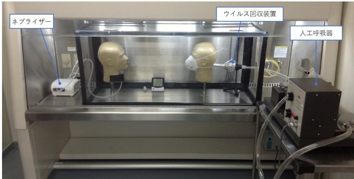
図1 BSL3 施設内に設置したウイルス噴霧チャンバー
